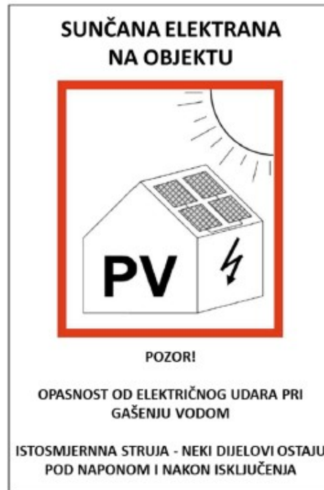
Primjer oznake upozorenja na sunčanu elektranu
